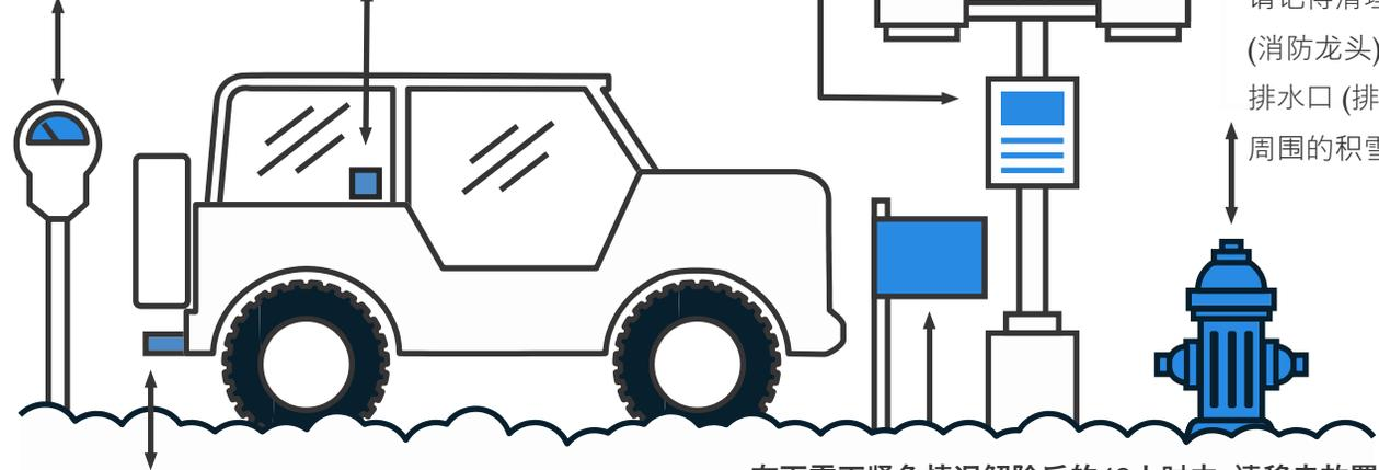
在启动汽车之前，请清除汽车排气管周围，至少一尺的积雪。
