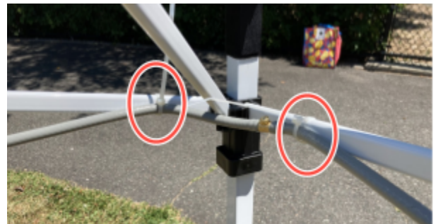
Ate el extremo de la manguera al marco de la carpa con velcro o una brida.
