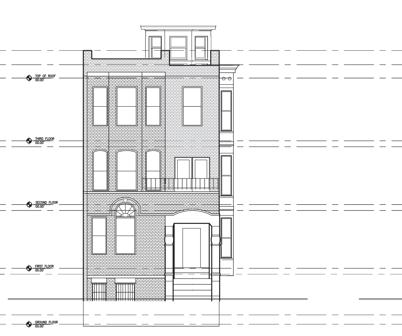
Front Elevation Scale: 1/8" = 1'- 0" 6
